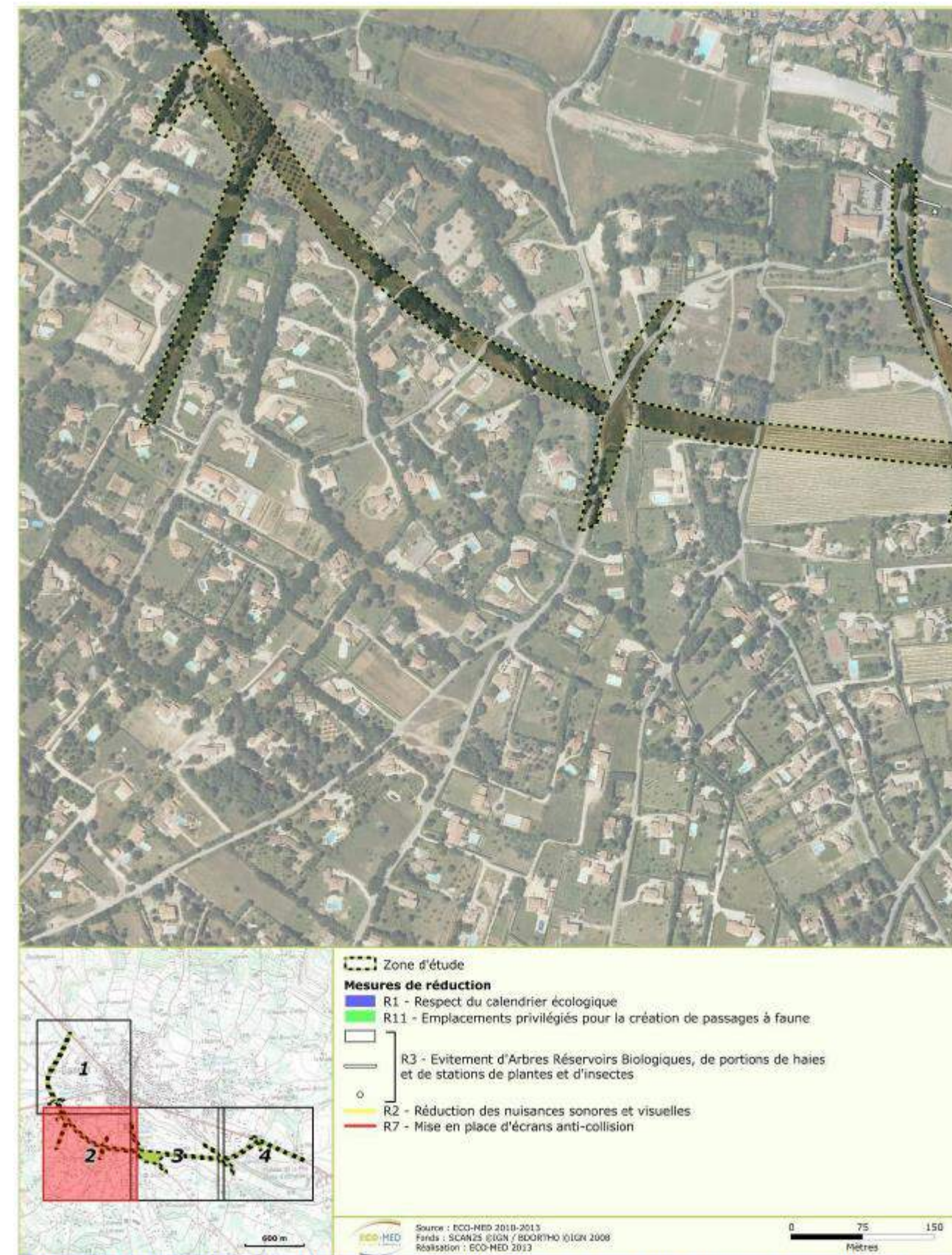
Figure 82 : Mesures de réduction en phase travaux sur la partie Faune-Flore, partie centre-ouest du tracé
